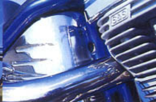
LGO-oljetanken har kylkanaler till batteriet.
